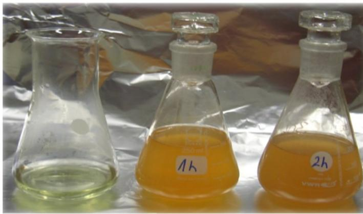
**Abbildung 23: 30 M-% MEA-H<sub>2</sub>O-Lösung nach Wärmebehandlung bei 95°C (unbehandelt sowie nach 1 bzw. 2 h)**
