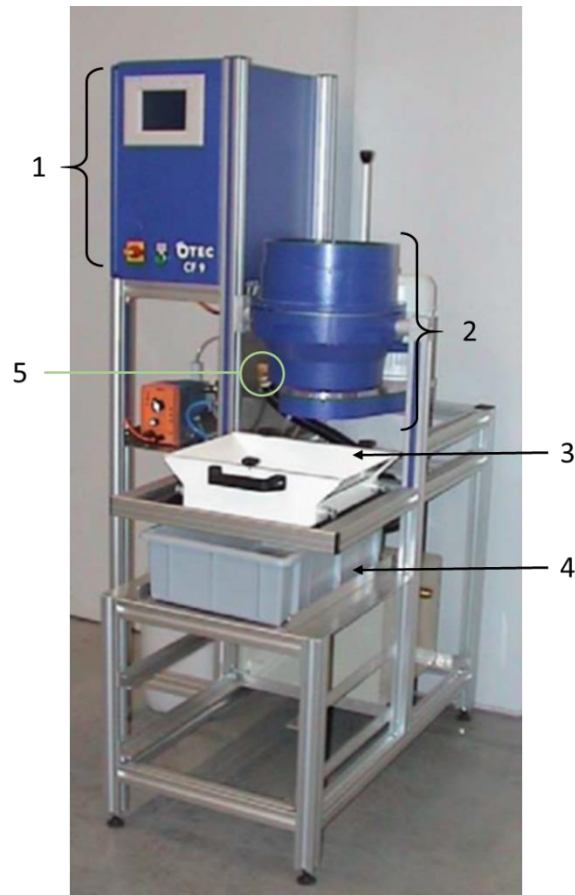
Abbildung 2-21: Tellerfliehkraftmaschine CF 1x18 des Herstellers OTEC GmbH [131] mit Nummerierung einzelner Komponenten
