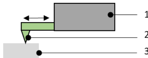
Abbildung 4-13: Schematische Darstellung einer taktilen Rauheitsmessung mit Nummerierung wichtiger Komponenten
