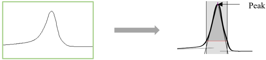
Abbildung 4-21: Ausschnitt aus der Aufheizphase des Thermogramms aus Abbildung 4-20 (links) und von einem bearbeiteten Thermogramm (rechts)
