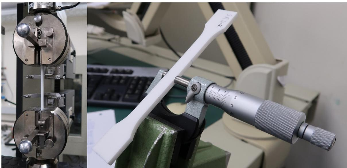
**Abbildung 5-7:** Zugprüfung und Querschnittsermittlung der Proben
