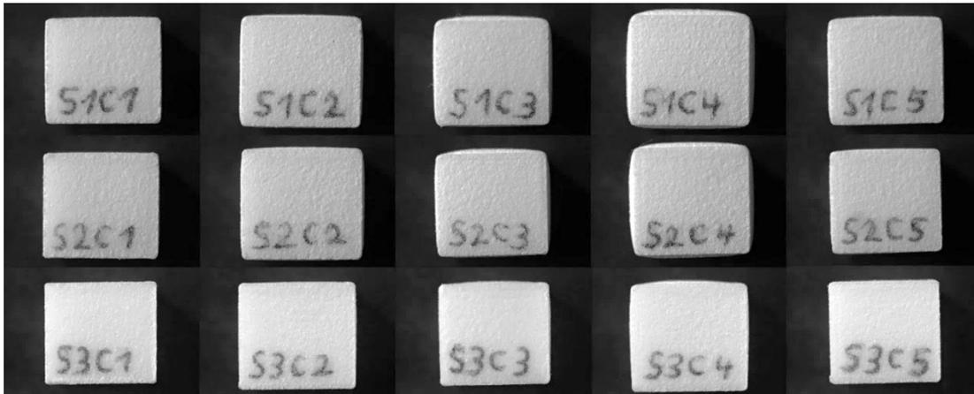
**Abbildung 6-26:** Betrachtung der entstandenen Probekörper mit den Sollmaßen 10 mm x 10 mm x 10 mm (x, y, z)
