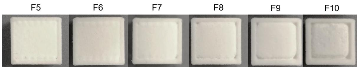
**Abbildung 6-38:** Ausprägung des Versatzes in Abhängigkeit zur Fokusstufe
