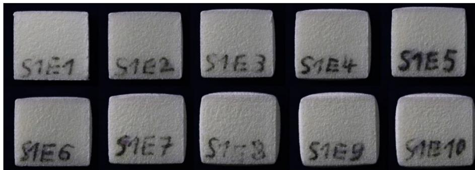
**Abbildung 6-28:** Bauteile mit C3-S1-Parametern und variierender Energiedichte
