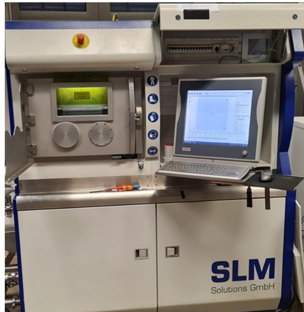
Bild 4-1: SLM 280 HL PBF-LB/M-Anlage.
