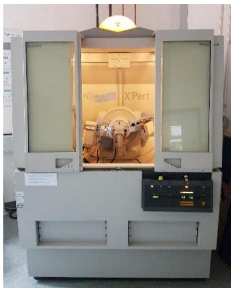
Bild 4-13: Röntgendiffraktometer X'Pert Pro des Herstellers PANalytical.
