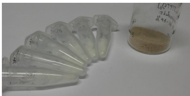
Abb. 5-4. Vergleich des Komplexes von \text{Na}_8[\text{Au}(\text{TPPTS})_3] vor der Reinigung (rechts) und nach der Reinigung (links).
