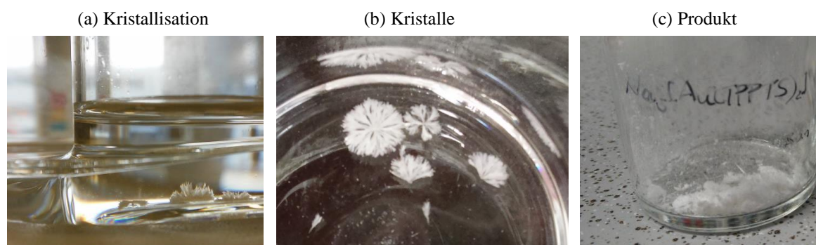
Abb. 5-6. Darstellung der Kristallisation (a), die Kristalle (b) und das Produkt (c) von \text{Na}_5[\text{Au}(\text{TPPTS})_2] .
