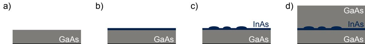
**Abbildung 2.1.1:** Schematische Darstellung des Stranski-Krastanow-Wachstums für selbstorganisierte Quantenpunkte. a) Auf eine möglichst reine und glatte Galliumarsenid-Schicht (GaAs) werden b) 1.5 Monolagen Indiumarsenid (InAs) abgeschieden. Aufgrund der etwa 7% größeren Gitterkonstante von InAs gegenüber GaAs wächst die InAs-Schicht verspannt auf. c) Wird weiter InAs abgeschieden bilden sich linsenförmige Inseln aus, welche anschließend d) mit GaAs überdeckt werden.
