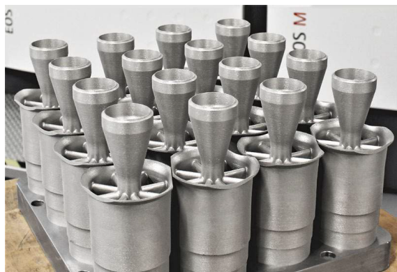
Abbildung 1.4: Beispiel für eine gelungene Marktintegration – PBF-LB/M-gefertigter Swirler von Siemens; Reduktion der Nachbearbeitungszeit von 6 h (Guss) auf 1 h [14]
