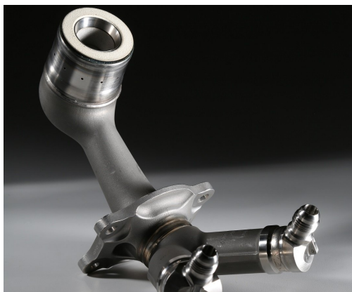
Abbildung 1.2: Kraftstoffdüse der Firma GE – Überführung einer 20-teiligen Schweißbaugruppe in ein monolithisches Einzelteil durch AM [5]
