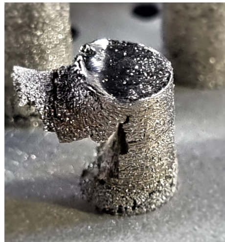
Abbildung 2.10: Katastrophales Versagen einer DMMC-Probe im PBF-LB/M-Prozess [18]
