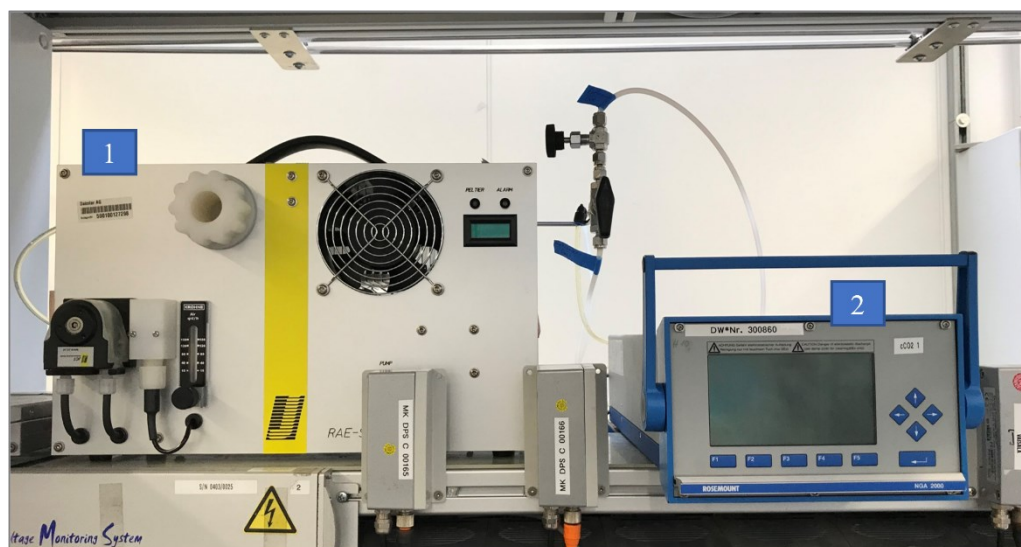
Abbildung 15: Hardware für die Gasanalytik der Auslassgase des Brennstoffzellenstacks (1: Messgasaufbereiter, 2: Analysegerät). Die genauere Position im Teststand kann Abbildung 11 entnommen werden
