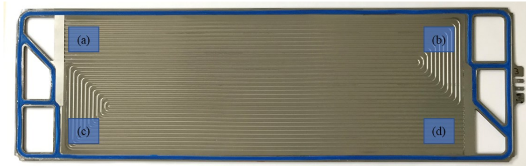
Abbildung 18: Bereiche der CCM REM Analysen: Anodeneinlass (a), Kathodenauslass (b), Kathodeneinlass (c) und Anodenauslass (d) am Beispiel einer Anodenhalschale mit Au-Beschichtung
