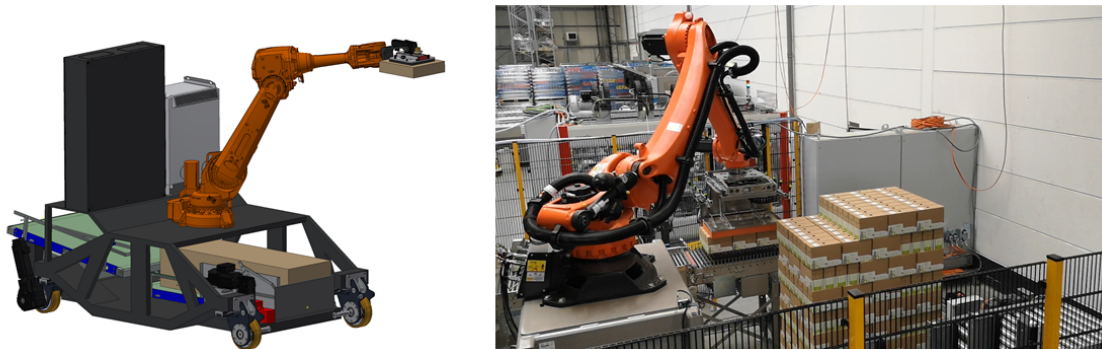
Bild 1 Beispiele für Handhabungssysteme mit Einzel-(links) und Gruppenhandling(rechts) (Quelle: Trapo GmbH, alle Rechte vorbehalten)
