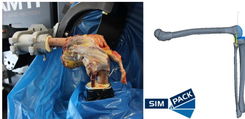
Abbildung 1: Experimentelles Setup am VIVO™ Gelenksimulator (links) und muskuloskelettales Mehrkörpermodell der unteren Extremität mit implementierten Bandstrukturen (rechts).
