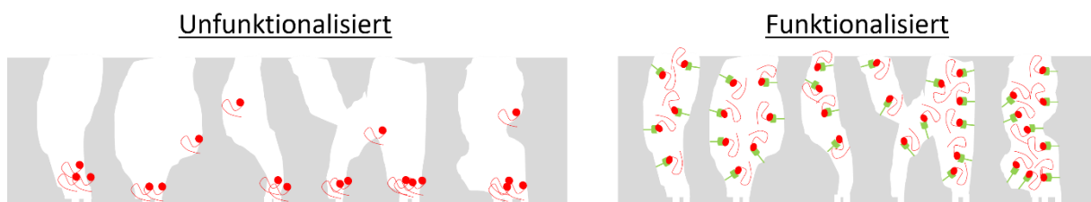
Abbildung 31 Vermutete Verteilung des Adsorberpolymers in unbehandelten Membranen (links) und mit Azidgruppen ausgestatteten Membranen (rechts).
