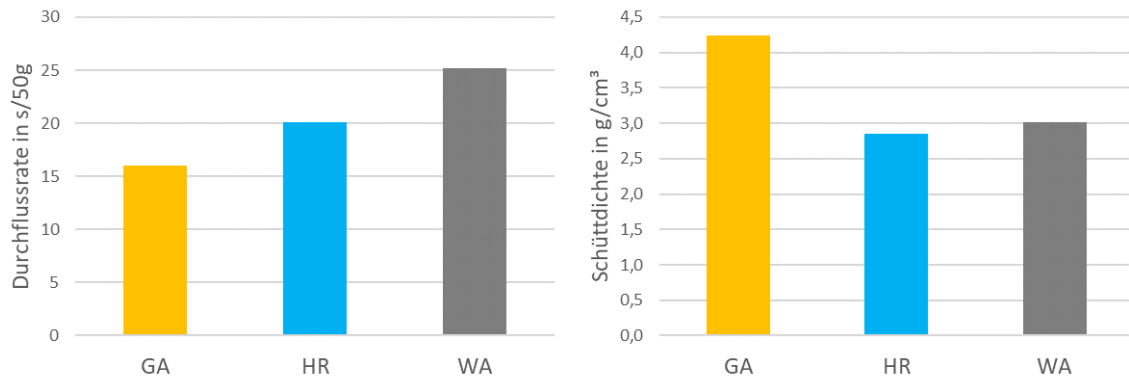
Abbildung 4-15: Durchflussrate und Schüttdichte von GA-, HR- und WA-Eisenpulver
