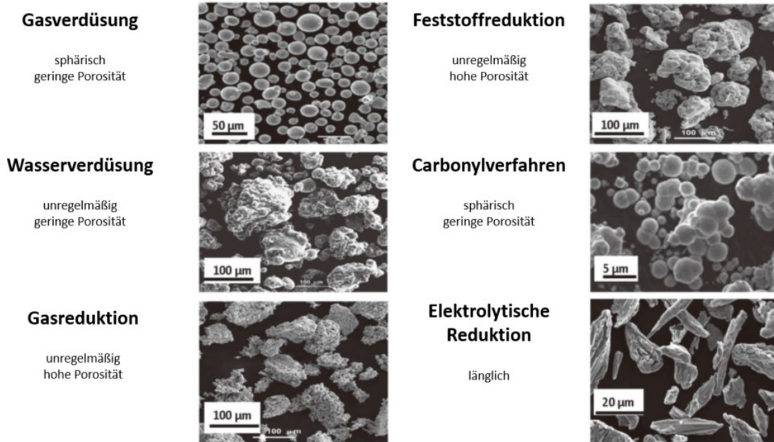
Abbildung 2-14: Pulvermorphologie von Eisenpulver von unterschiedlichen Herstellungsmethoden nach [106]
