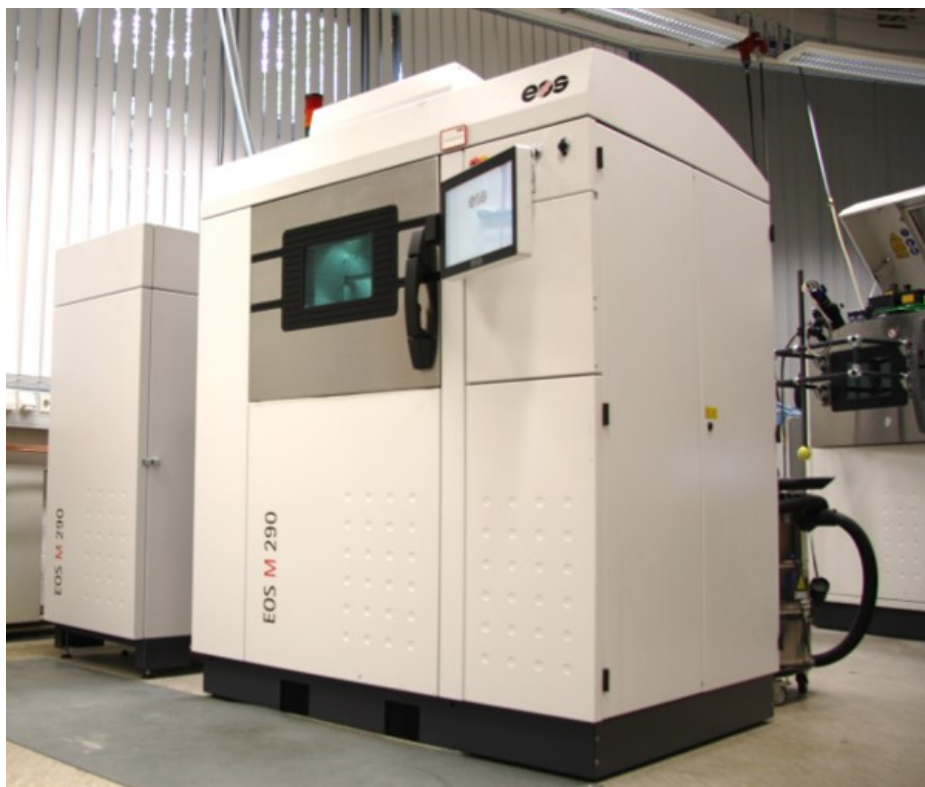
Abbildung 3-1: PBF-LB/M -Anlage des Typs EOS M290
