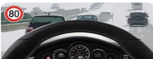
Die letzten Meter ins Skigebiet - Es **beginnt heftig zu schneien**. Anhand der umfassenden Sensorik erfasst das Fahrzeug das **schlechte Gripniveau** und das Tempolimit. Um den Fahrer in dieser Situation zu schützen wird der **Fahrzeugabstand** und **Kurvengeschwindigkeit** auf maximale Sicherheit getrimmt
