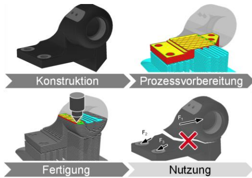
Bild 1 Prinzipdarstellung des klassischen Produktentstehungsprozesses mit Versagen aufgrund anisotroper Material Eigenschaften
