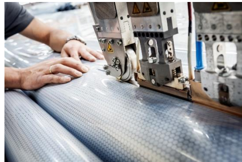
Bild 3 Verschweißung von ETFE-Folien mittels einer Verfahrsschweißmaschine (Quelle, ©: Vector Foiltec GmbH)
