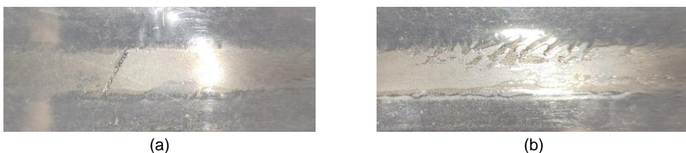
Bild 51 Schweißnahtfehler: (a) undichte Schweißnaht, (b) unebene Schweißnahtkante, Fotos: UDE/IML
