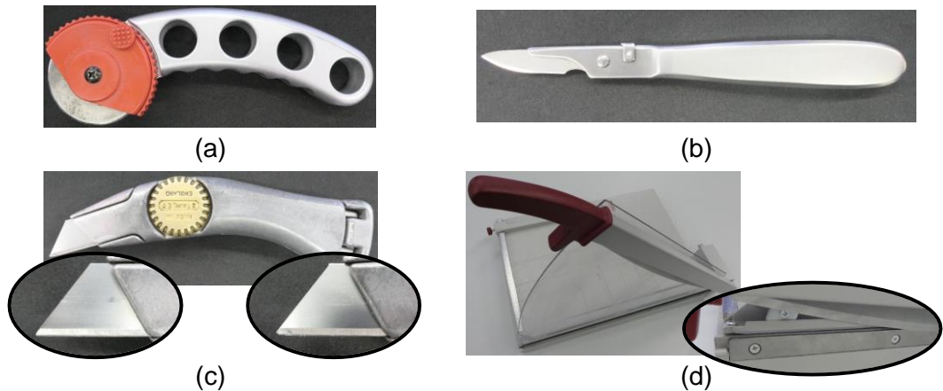
Bild 23 Für die Optimierung der Herstellmethode verwendete Zuschnittswerkzeuge; (a) Rollschneider, (b) Skalpell, (c) Cuttermesser mit neuer Klinge (Sch. Cutter, links) und sichtbar abgenutzter Klinge (St. Cutter, rechts), (d) Hebelschneider, Fotos: UDE/IML
