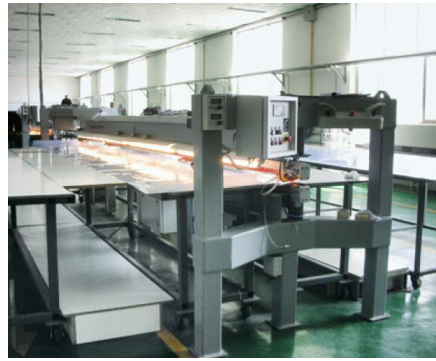
Bild 4 Von Vector Foiltec entwickelte Heizbalkenschweißmaschine mit fester Schweißnahtlänge (Quelle, ©: Vector Foiltec GmbH)
