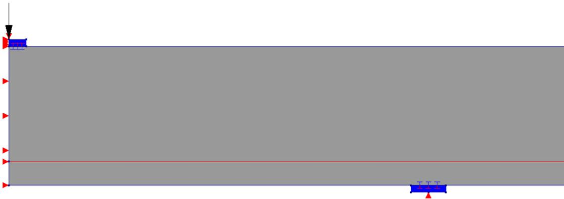
Bild 6-16: FE-Modell zur Nachrechnung der Querkrafttragversuche ohne Querkraftbewehrung
