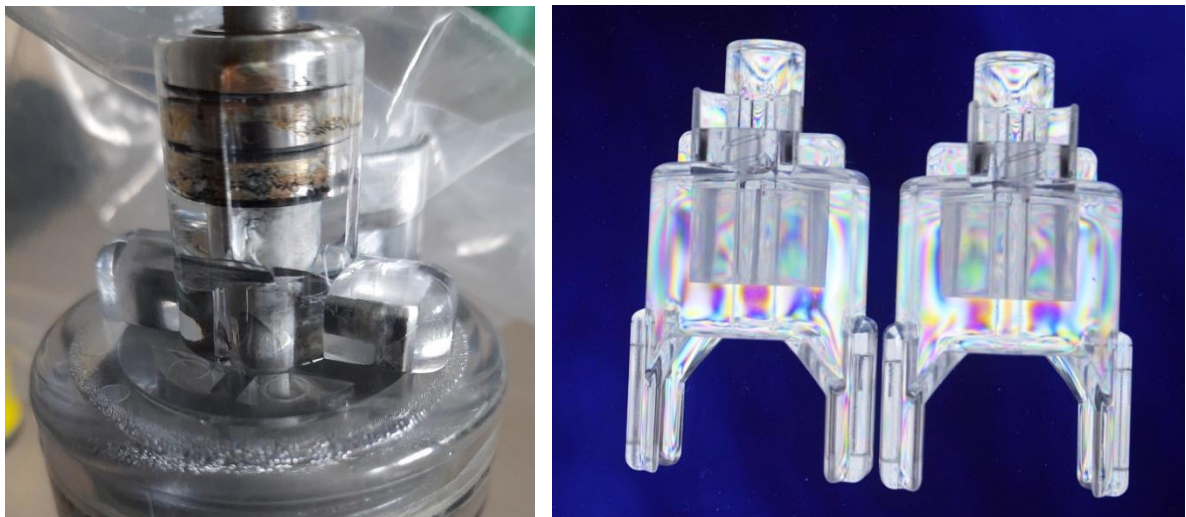
Abb. 18: Risse im Bereich der shaft seals beim MCM (links), spannungsoptische Messung (rechts) durchgeführt von K. Tell, DLR.
