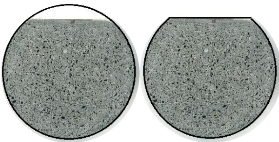
Abb. 28: Ideelle Außenfläche (links) und tatsächliche Außenfläche (rechts) einer horizontal erstarrten Probe mit reduzierten Zylinderquerschnitt.
