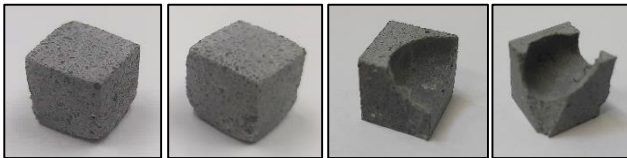
Abb. 59: 10 mm Würfel der Mischung N-R , Ig (links), \mu g mit großen offenen Poren (rechts).
