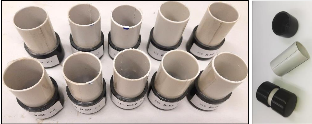
Abb. 22: Rohrschalung für die Proben aus dem LM .
