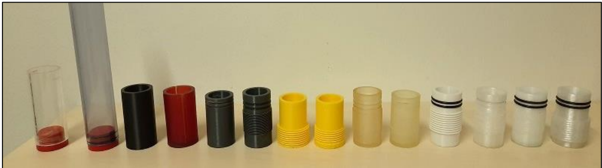
Abb. 11: 3D-Druck Prototypen und Entwicklungsschritte des MCMs ( mixing chamber ).
