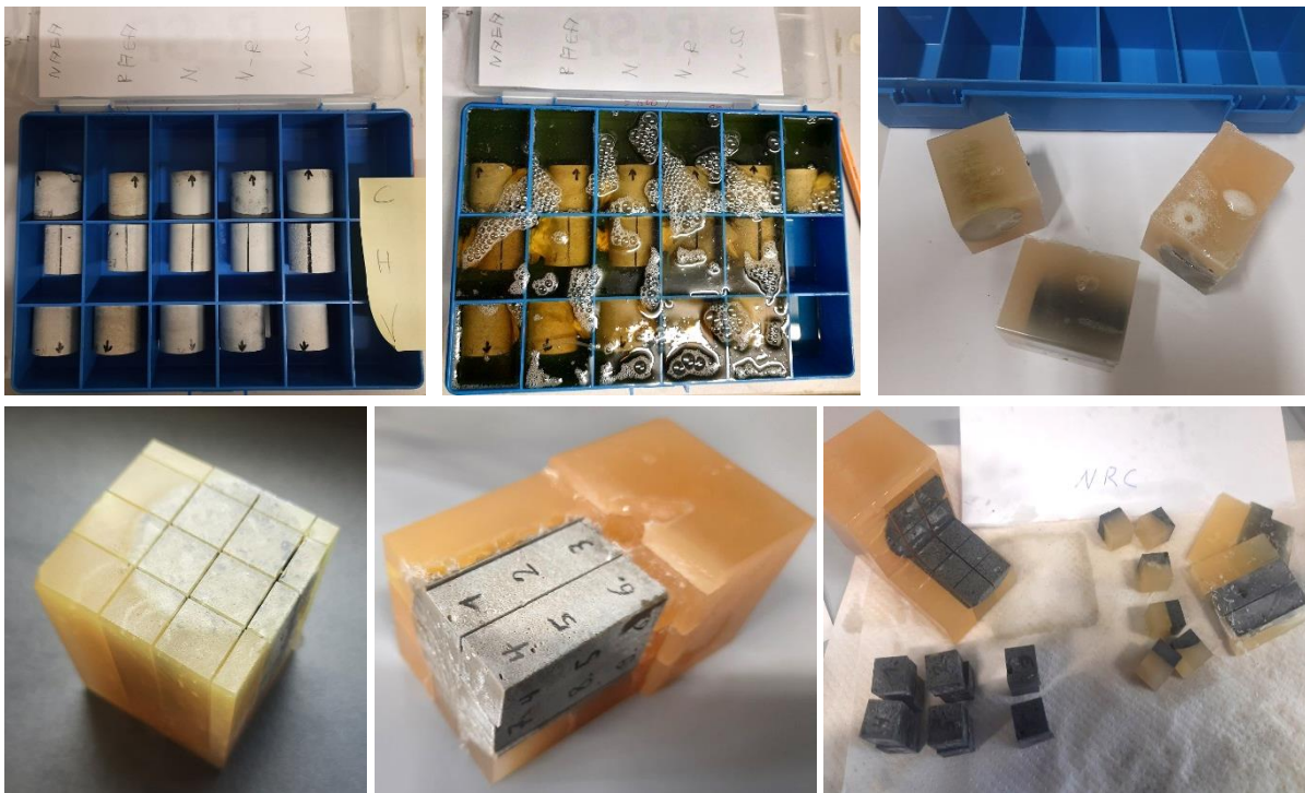
Abb. 25: Zylinder in Sortierkasten a) ausrichten, b) einkleben und c) ausschalen, d) Schnittbild in Längsrichtung, e) Beschriftung der Würfel, f) abgeschlossener Schneideprozess mit 10 mm Würfeln.
