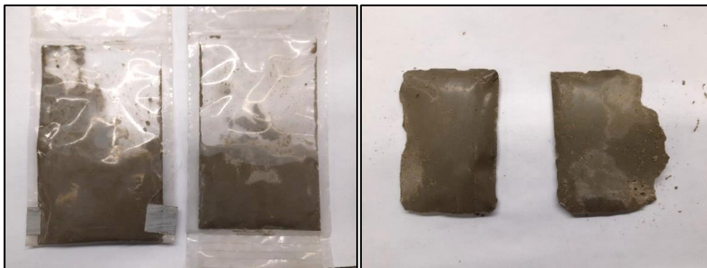
Abb. 9: Frische (links) und erhärtete Zementleimprobe (rechts) bei Verwendung der Burst Pouches .
