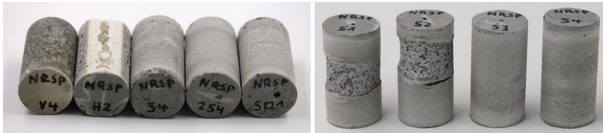
Abb. 36: Proben der Mischung N-R-SP im Vergleich a) von links nach rechts V, H, C5, C25, C50 (links) und b) die 4 C-Proben mit 5 rpm im Klinostaten rotiert (rechts).
