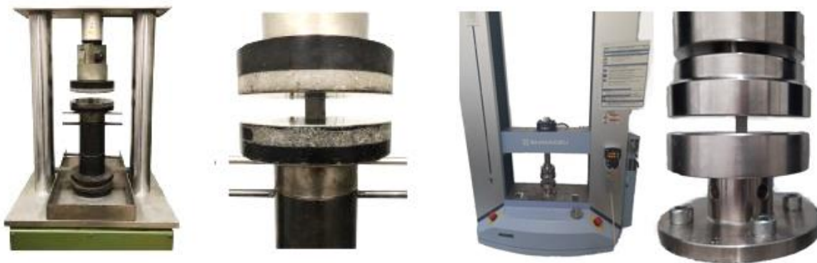
Abb. 32: Verwendete Druckprüfmaschine der Firma Walter & Bai für die Zylinderproben (links) 7 und der Firma Shimadzu für die Würfel mit 10 mm Kantenlänge (rechts).
