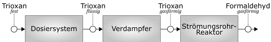
Abbildung 4.6: Schematische Darstellung der drei Teilsysteme der Strömungsrohrreaktor-Anlage mit den zugehörigen Aggregatzuständen des Trioxans bzw. Formaldehyds.
