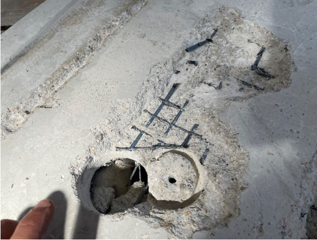
Abbildung 8: Kernbohrung durch Prüfkörper [Quelle: TU Dresden, IBB]
