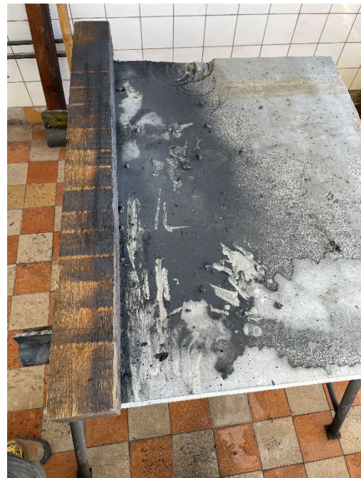
Abbildung 5: Ablagerung von Carbonstaub infolge der Konvektionierung von Stäben [Quelle: TU Dresden, IBB]
