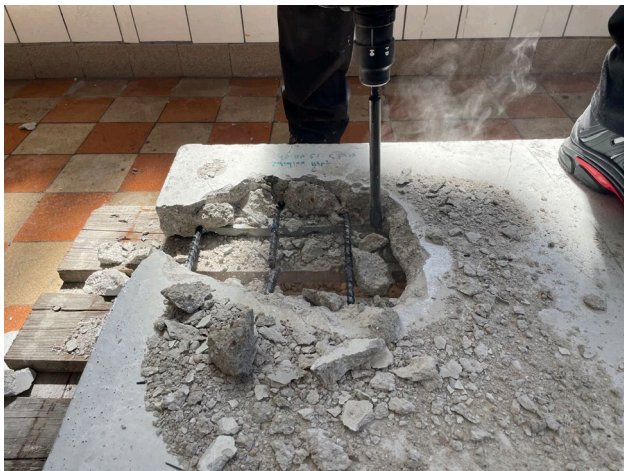
Abbildung 9: Stemmen am Prüfkörper [Quelle: TU Dresden, IBB]
