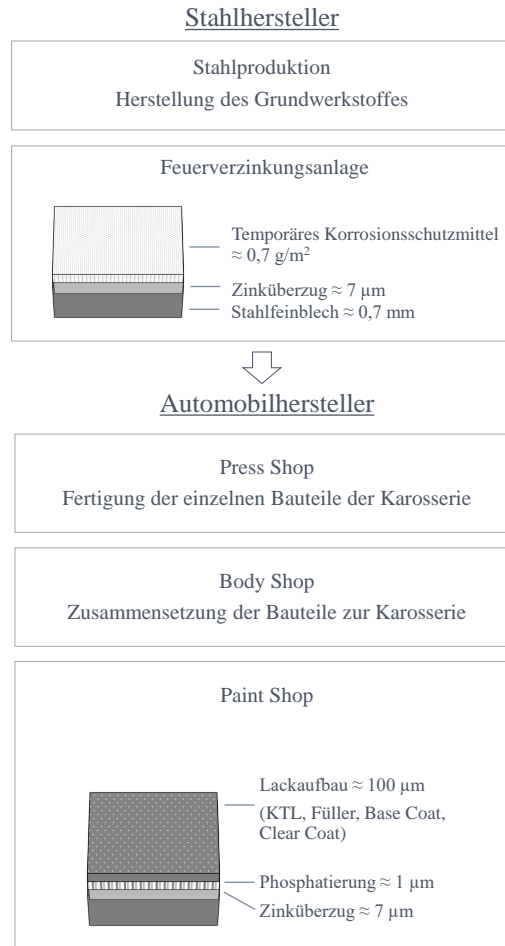
Abbildung 1.1: Fertigungskette von der Stahlproduktion beim Stahlhersteller bis zur Lackierung der Karosserie beim Automobilhersteller [2].
