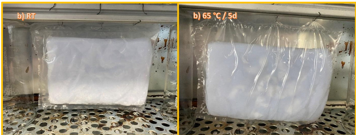
Abbildung 86: 92 g schwere Paraffinprobe vor und nach thermischer Belastung im Ofen bei 65 °C (b = 4 w% TBPMN/UHMWPE 50/50)
