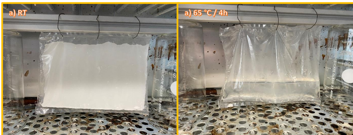
Abbildung 85: 92 g schwere Paraffinprobe vor und nach thermischer Belastung im Ofen bei 65 °C (a = unstabilisiert)
