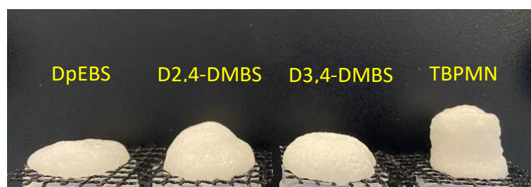
Abbildung 88: Verformung von zylinderförmigen, stabilisierten PEG 8000-Proben nach 20 Schmelz-/Erstarrungszyklen mit verschiedenen Isosorbid-Derivaten (2 w% Komposite (70% Gelator / 30% UHMWPE))
