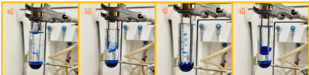
Abbildung 77: Aufnahme von eingefärbtem TCB in einen Aerogelkörper
