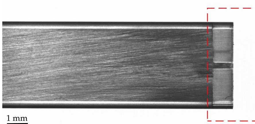
Abbildung 5.10: Schneidstempel am Ende seiner Lebensdauer (200.000 Hub). Der Verschleiß ist über die komplette Eingrifftiefe ersichtlich (rote Rahmen).
