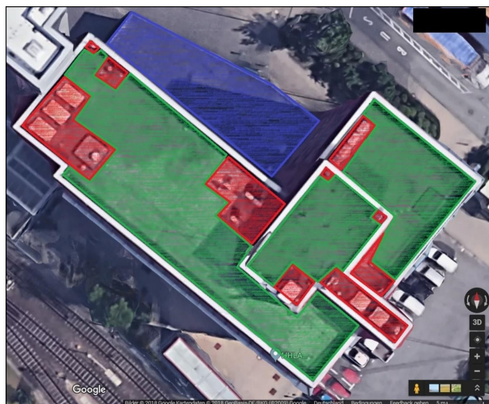
Abbildung 4.4: Für PV geeignete Dachfläche des CTT. Grüne Flächen können mit PV-Modulen ausgestattet werden. Die blauen Flächen sind verschattet, Quelle: Google Maps, eigene Berechnung
