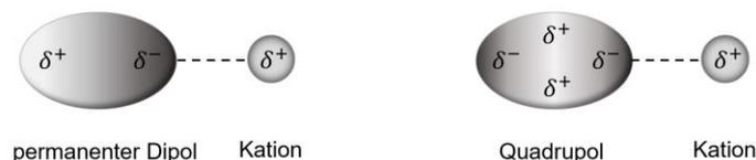
**Abbildung 12: Schematische Darstellung von Ion-Dipol- (links) und Ion-Quadrupol-Wechselwirkungen (rechts)**
