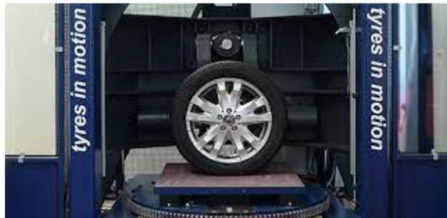
**Abbildung 2.35:** Steifigkeits-Reifenprüfstand (fka GmbH 2022c)
