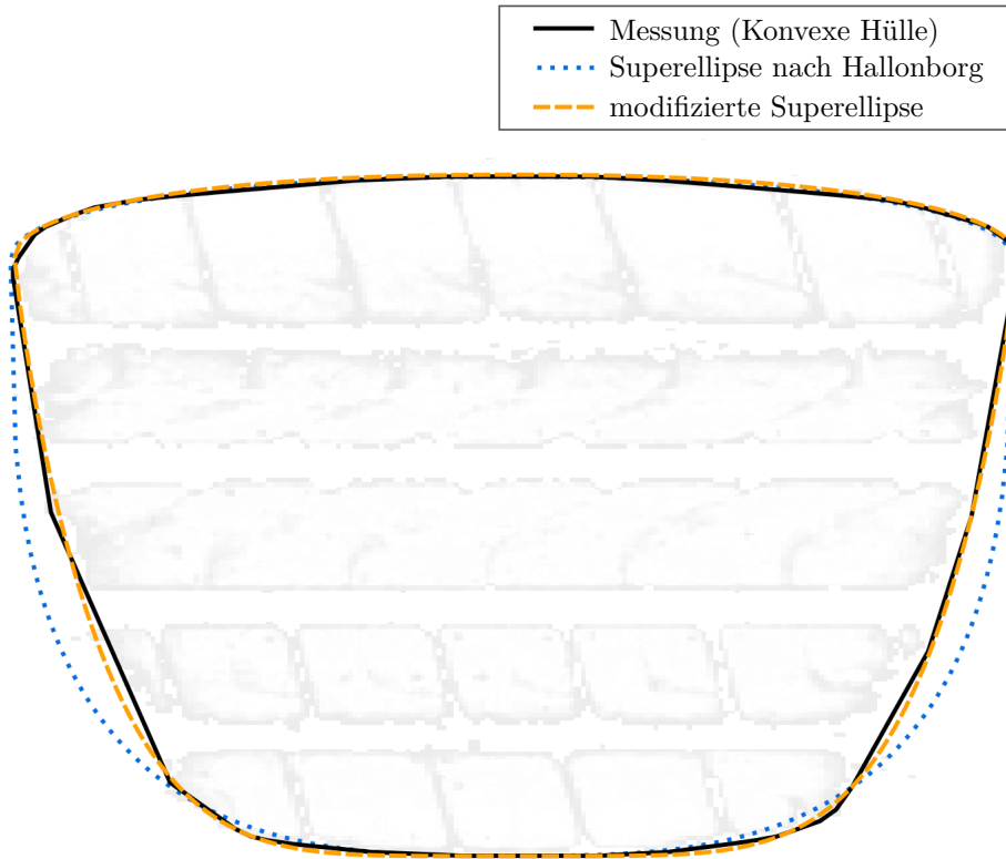
Abbildung 4.4: Messung der Reifenaufstandsfläche und Modellierung dieser mit zwei verschiedenen Superellipsen.
