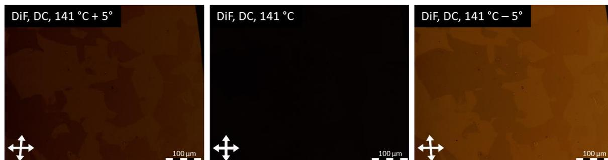
**Abbildung 88** POM-Aufnahmen des DIF mit um 5° nach links bzw. rechts gedrehtem und gekreuztem Polarisationsfilter.
