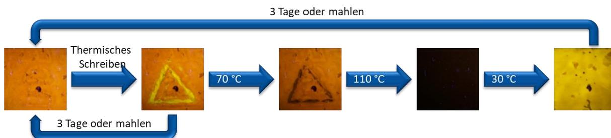
**Abbildung 72** Darstellung des „thermo-patternings“. Nachdruck mit Genehmigung von [136]. Copyright [2022] American Chemical Society.
