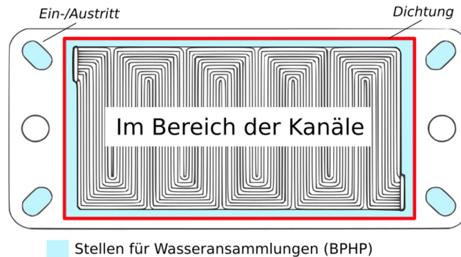
Abbildung 3.6: Mögliche Stellen für Wasseransammlungen am Beispiel einer BPHP im ZBT-Design
