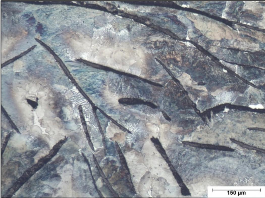
**Abbildung 72: Initiales Gefüge Außenwand (Probenlage 6).**
