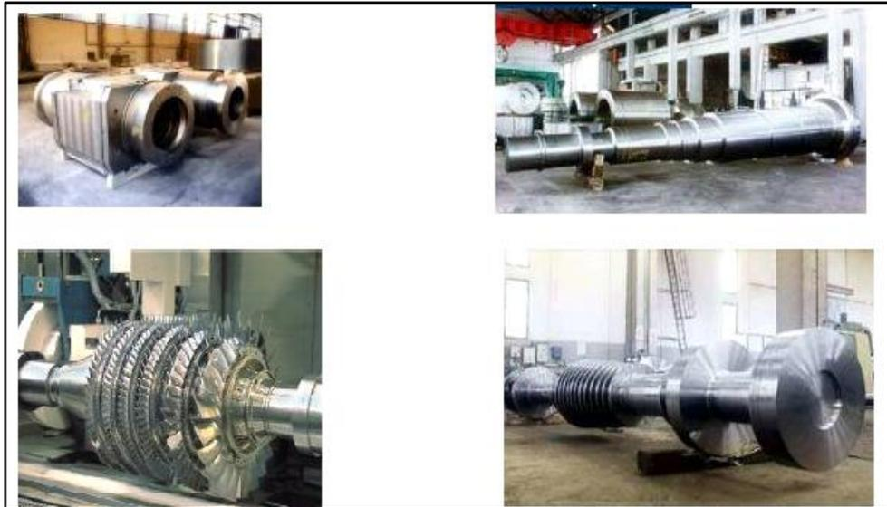
**Abbildung 12: Bauteile, die aus Blockgussrohlingen erzeugt wurden (17).**
