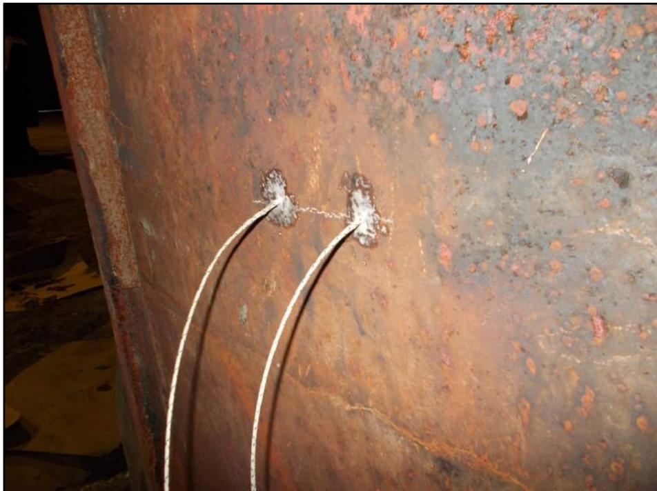
**Abbildung 70: Anbringung von Thermosonden in der Kokillenwand.**
