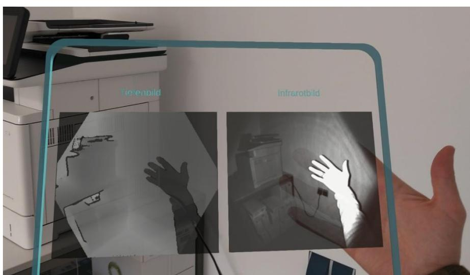
**Abbildung 56: Tiefenbild (links) und Infrarotbild (rechts) (eigene Abbildung)**
