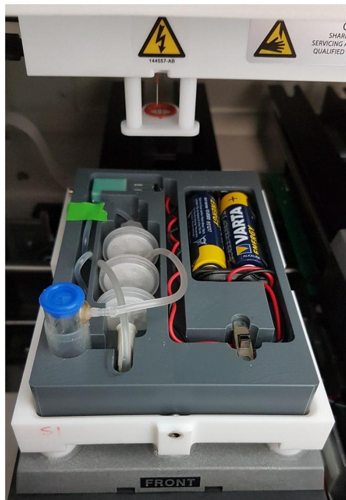
Abbildung 45: Präparierter und für die zeitaufgelöste Enzym-Reaktion im *Inlet Sample Tray* eingesetzter Reaktor.
