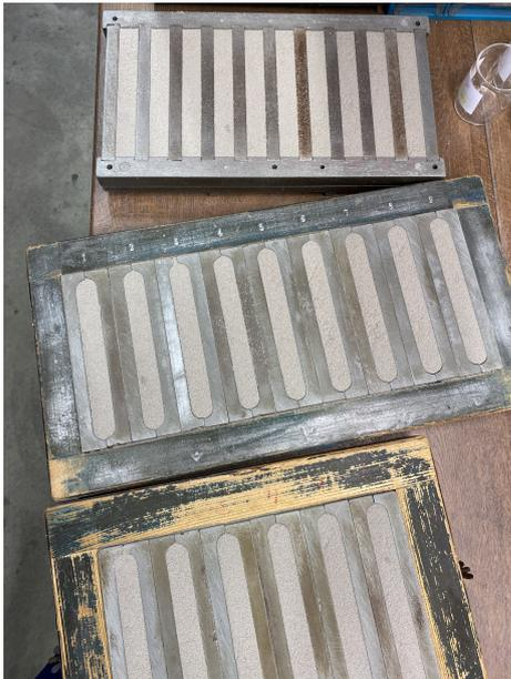
Abbildung 2.11: Formkästen mit Prüfstäben
