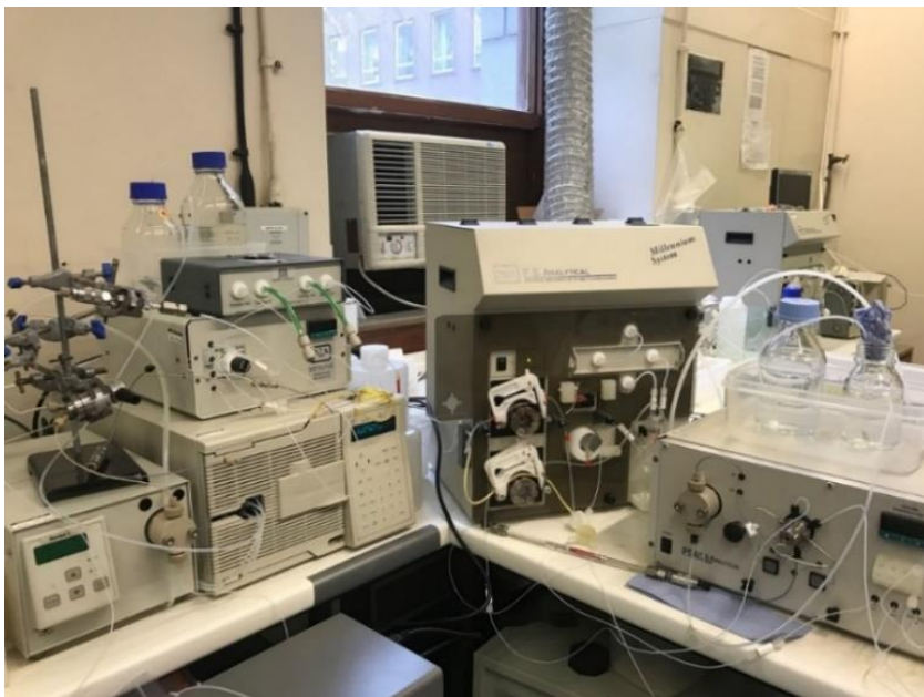
Abbildung 42: Instrumenteller Aufbau der Online-SPE-CV-AFS für die Analyse von Quecksilber, Eigentum der TESLA-Arbeitsgruppe von Prof. Jörg Feldmann (King's College, University of Aberdeen).
