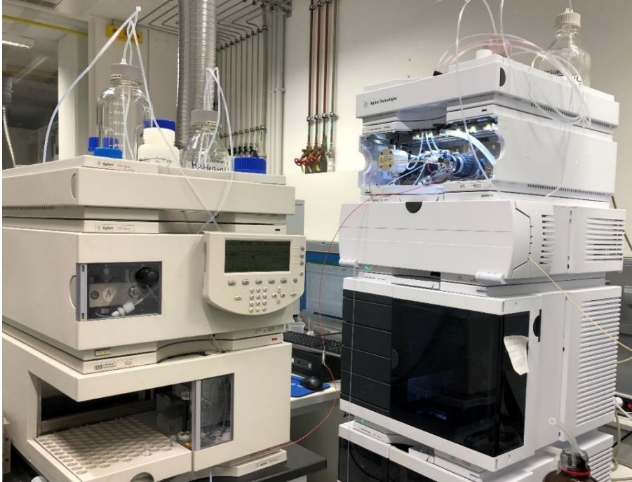
Abbildung 29: Instrumenteller Aufbau für die Entwicklung einer Online-Anreicherung (links: 1100 Series HPLC mit binärer Pumpe von Agilent Technologies, rechts: 1260 Prime II HPLC mit eingebautem Flexible Cube von Agilent Technologies).
