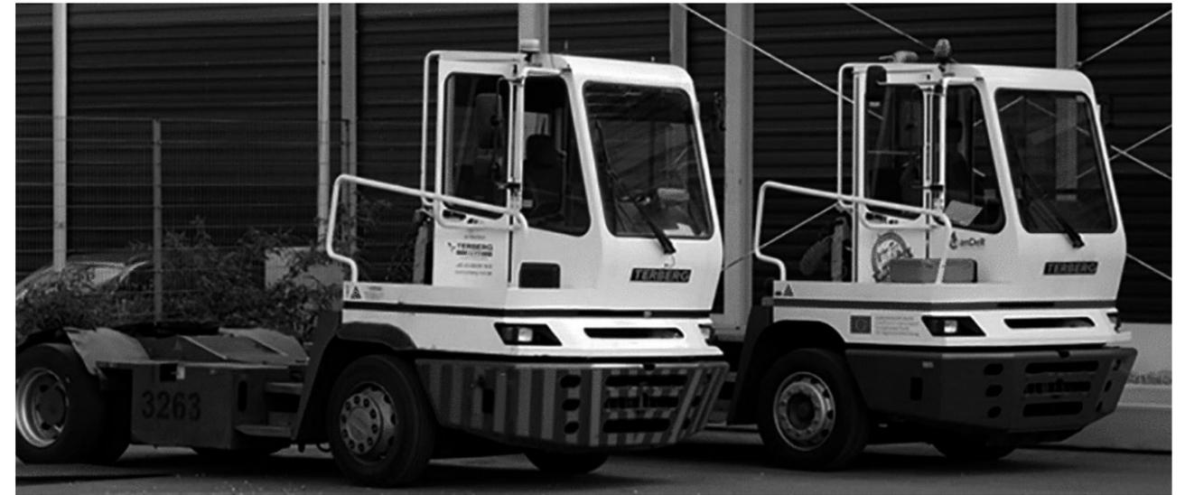
(1) Dieseltreibender Terminaltraktor (links) und erdgasbetriebener Terminaltraktor (rechts)
