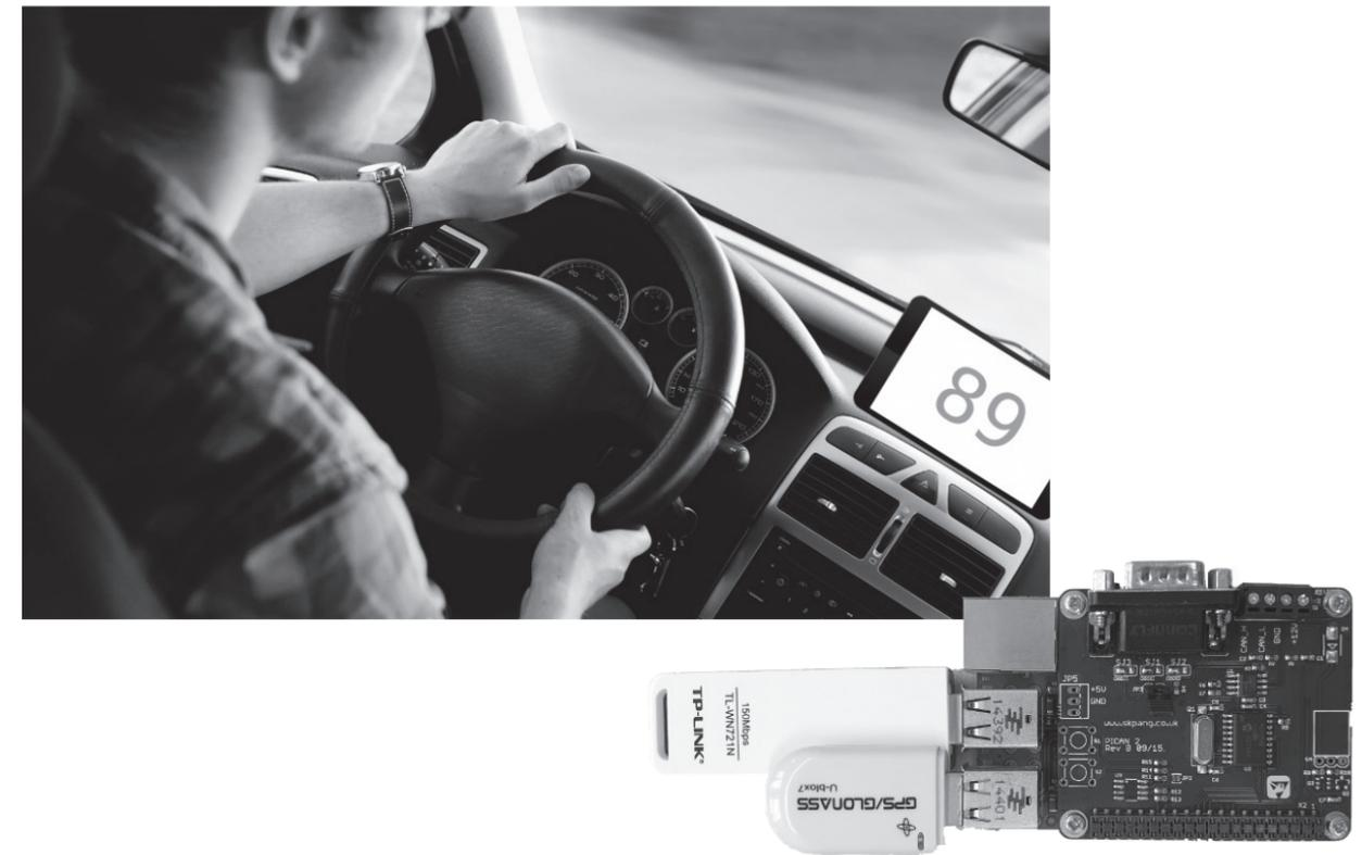
(1) Der Messaufbau: ein Raspberry Pi 2 mit einer PiCAN2 Karte angeschlossen am CAN-Bus. Anhand der Radgeschwindigkeiten wird ein Score zwischen 0 und 100 berechnet. Ein Score von 100 entspricht einer sicheren Fahrweise.
