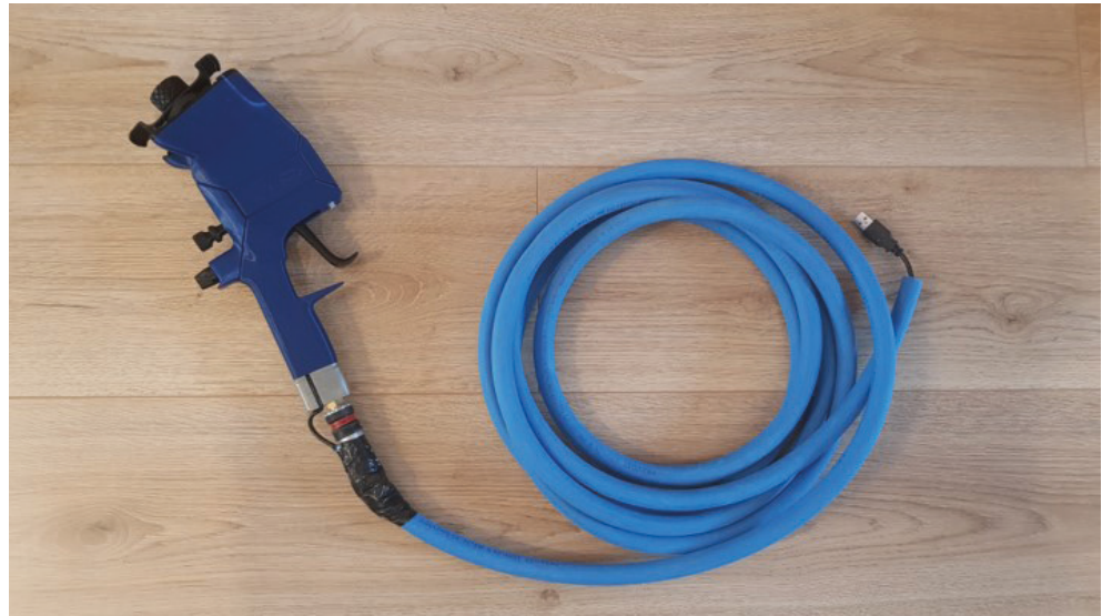
Abb. 2: 3D-Druck einer nachgebauten Lackierpistole mit Druckschlauch.
