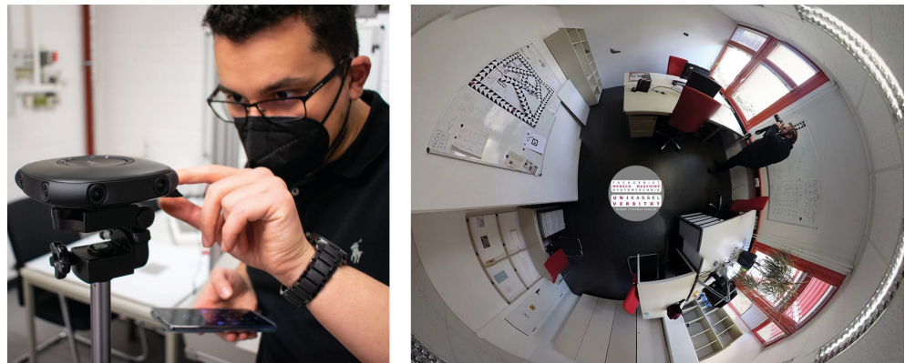
Abb. 1: Vorbereitung der 3D-360°-Kamera vor der Aufnahme des Raums (links) und Ausschnitt aus dem aufgezeichneten Video in der Fischaugen-Ansicht mit einem Handwerker bei der Dokumentation von Wandschäden (rechts).
