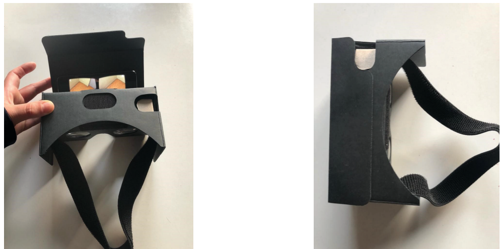
Abb. 2: VR Brille. Cardboard + mobiles Endgerät (360°-Video im Cardboard-Modus).
