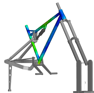
Abbildung 3 Mehrkörpermodell eines Fahrradrahmens mit elastischem Hauptrahmen im Prüfstandsversuch nach DIN EN ISO 4260-6 4.3 Dynamische Prüfung mit pedalerenden Kräften [4]. Dargestellt ist der Rahmen im Zeitpunkt der größten Belastung.
