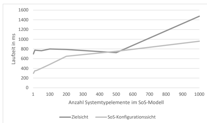
Abbildung 9.11: Einfluss der Anzahl der Systemtypen im SoS-Modell auf die Dauer der Sichterstellung
