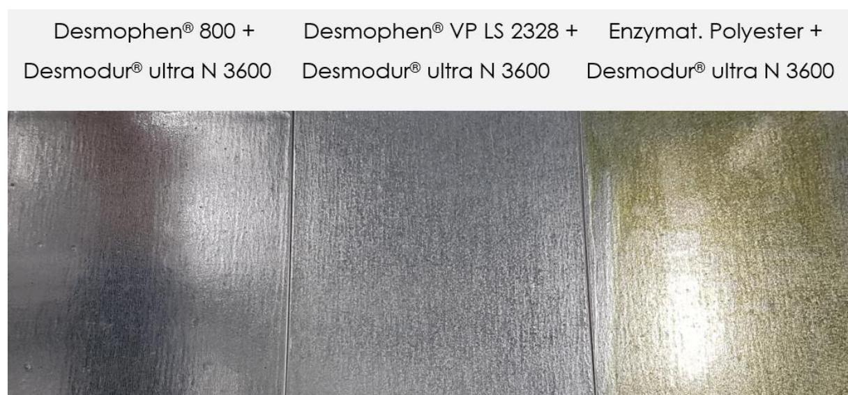
Anhang Abb. 101: Beschichtungen von Desmophen<sup>®</sup> 800 (li.), Desmophen<sup>®</sup> VP LS 2328 (mi.) und enzymat. Polyester (re.), vernetzt mit Desmodur<sup>®</sup> ultra N 3600, nach 30 Min. bei 140 °C
