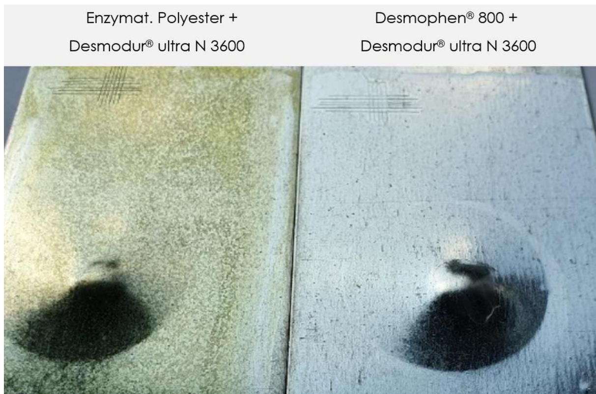
Anhang Abb. 104: Ergebnisse der Gitterschnitt- und Schlagprüfung von enzymat. Polyester (li.) und Desmophen® 800 (re.), vernetzt mit Desmodur® ultra N 3600, nach 30 Min. bei 140 °C
