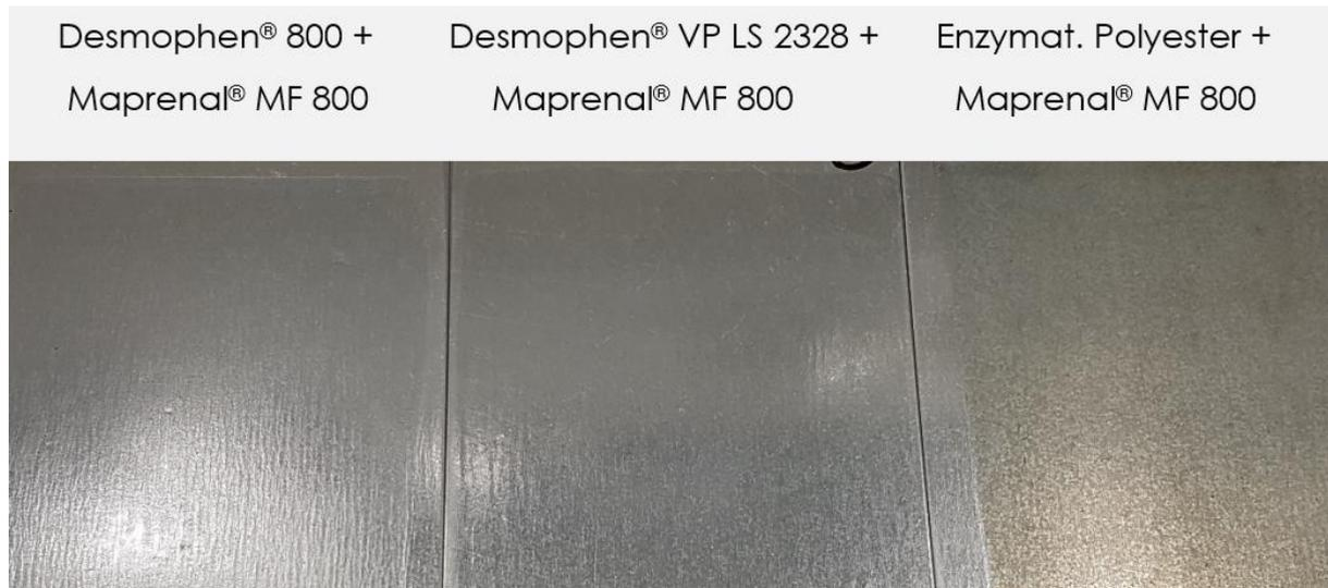
Anhang Abb. 102: Beschichtungen von Desmophen® 800 (li.), Desmophen® VP LS 2328 (mi.) und enzymat. Polyester (re.), vernetzt mit Maprenal® MF 800, nach 30 Min. bei 140 °C
