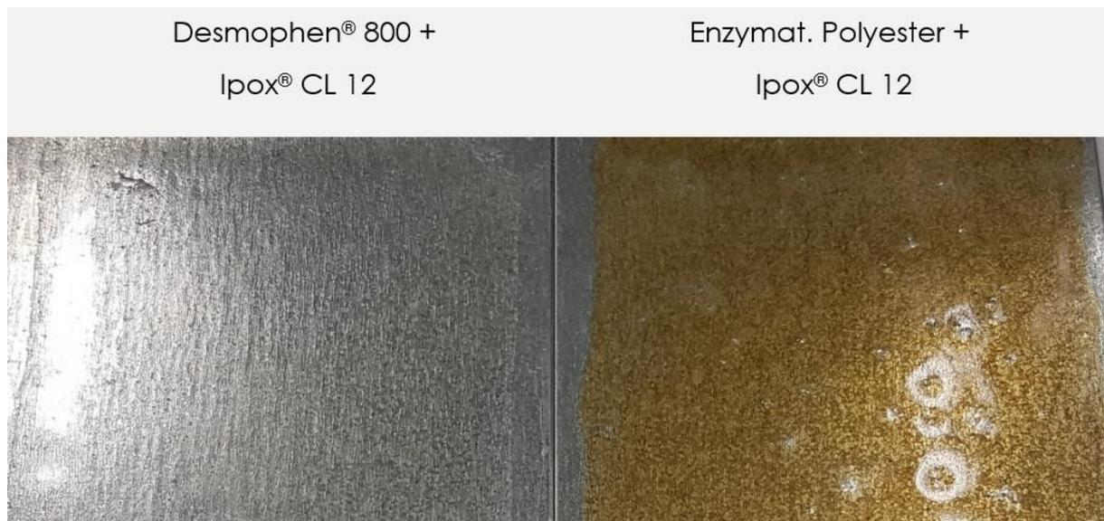
Anhang Abb. 103: Beschichtungen von Desmophen® 800 (li.) und enzymat. Polyester (re.), vernetzt mit Ipox® CL 12, nach 30 Min. bei 140 °C
