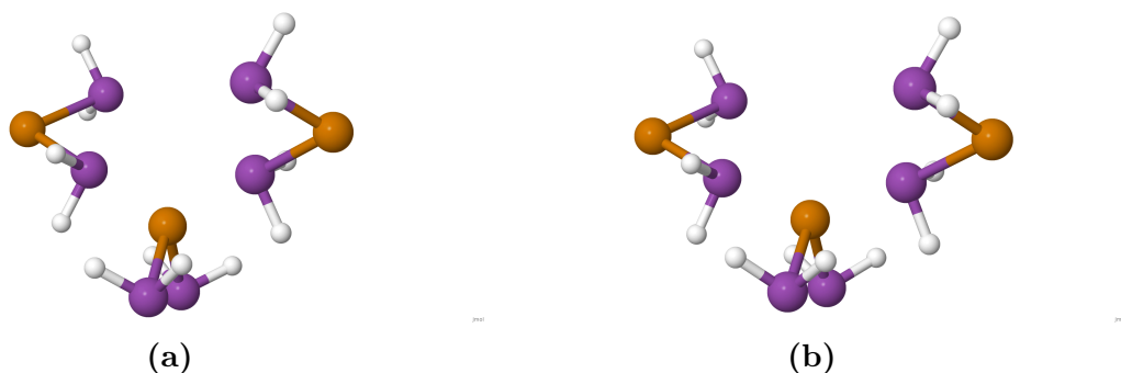
Abbildung 4.23: Geometrien der Strukturen, die sich aus den SCS-MP2/d-korr/aug-cc-pwCVTZ Ext_fix- und Ext_fix.+Te-Rechnungen am Trimer Up ergeben.
