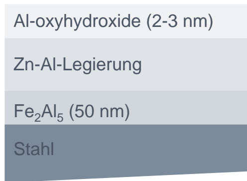
Abbildung 2.3: Schematische Darstellung des Schichtaufbaus von Z-Material bestehend aus dem Zn-Al Legierungsüberzug und dem Grundsubstrat nach [28]
