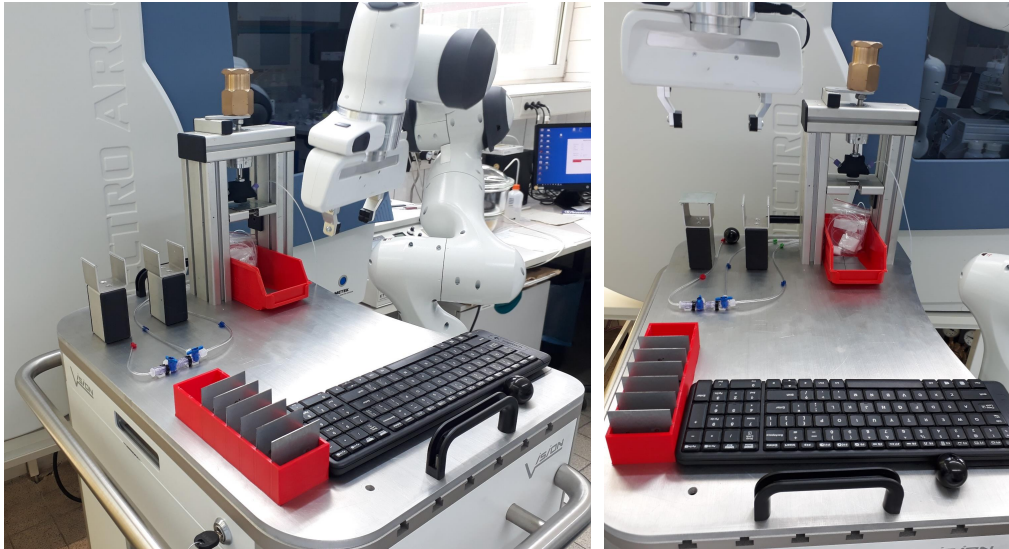
Abbildung 6.4: Gefertigter Arbeitsraum mit Cobot für die automatisierte FC-ICP-OES-Methode
