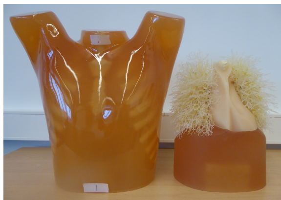
Abb. 2.7: Ventrale Ansicht des anthropomorphen Lungman-N1-Phantoms PH-1 R16511 zur Nachbildung der Thoraxanatomie eines erwachsenen Mannes. Die Brustwandreplikation mit synthetischen Knochen (links) kann der Kombination aus einem artifiziellen Lungengefäßsystem inklusive Mediastinum und einem Zwerchfell-Abdomen-Block (rechts) aufgesetzt werden.
