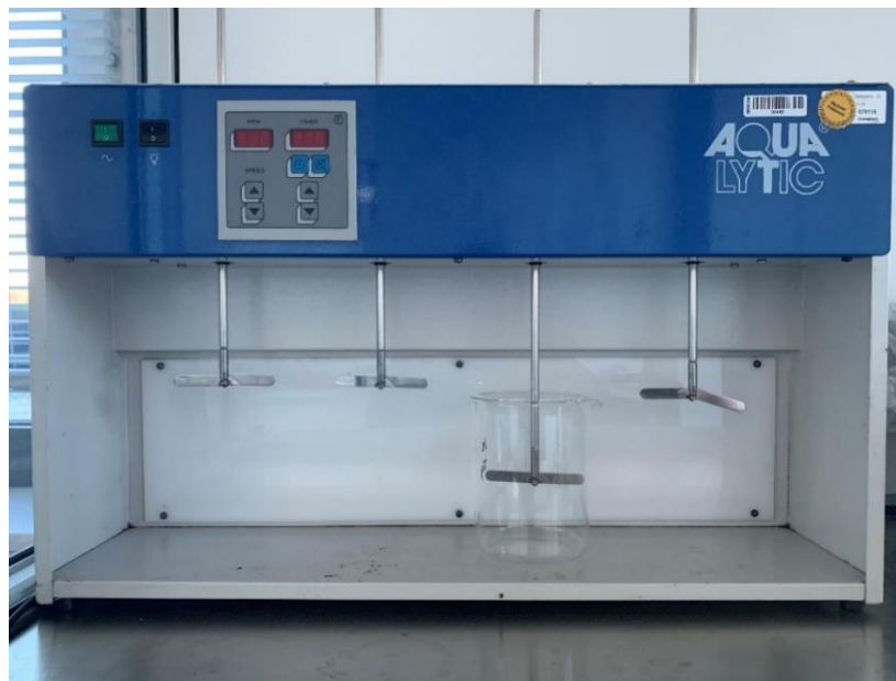
Abbildung 3.1.1-1: Für Adsorptions- und Fällungsversuche verwendetes Reihenrührwerk der Fa. Aqualytk
