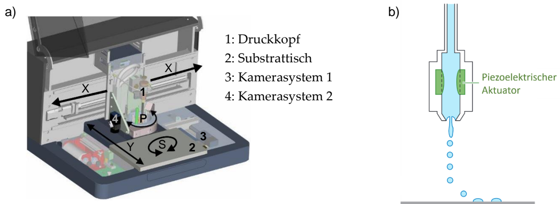
Abbildung 4.7: a) Schematischer Aufbau des PiXDRO LP50 Tintenstrahldruckers aus [83] und b) schematische Darstellung der Tropfenformation nach dem piezoelektrischen „Drop-on-Demand“-Prinzip (DOD) nach [84] .
