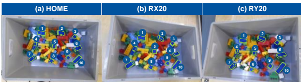
Abbildung 11 Bilder der blauen LEGO Bauteile in einer Kiste für die Posen HOME, RX20 und RY20
