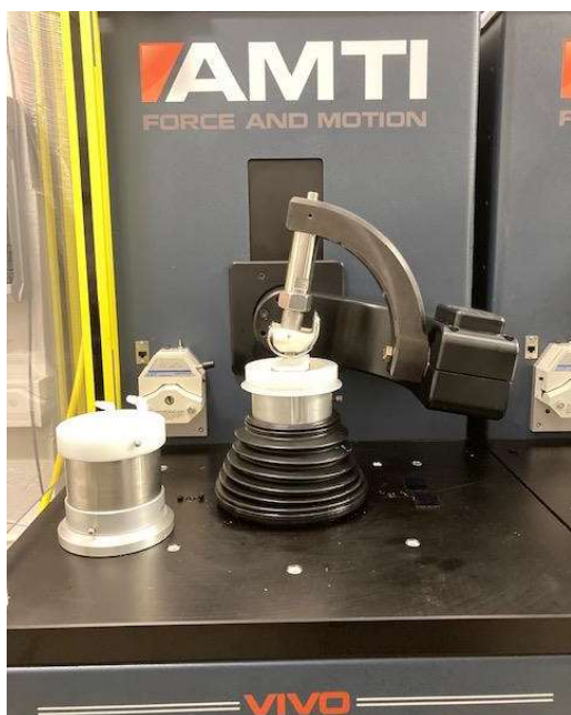
Abbildung 1: VIVO-Gelenksimulator mit künstlichem Kniegelenk
