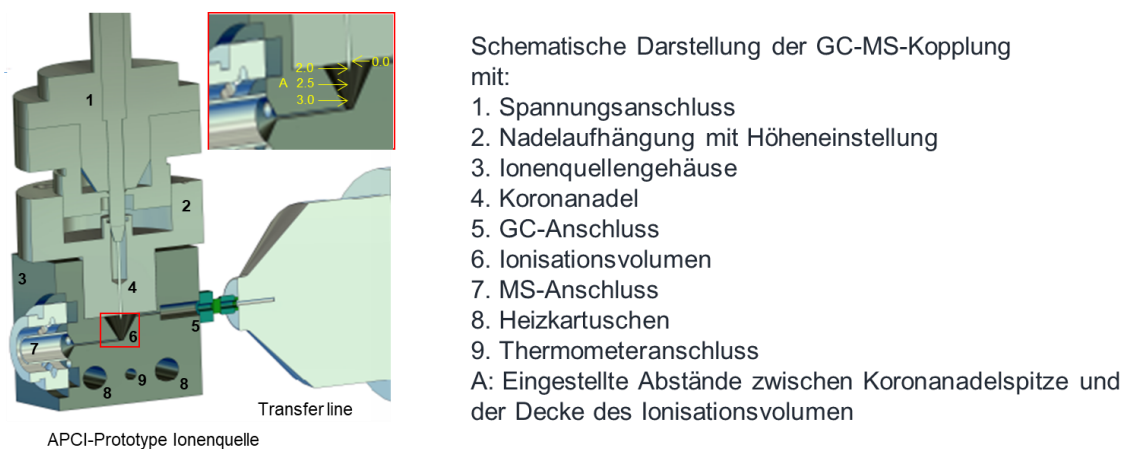
Abbildung 21. Schematische Darstellung der Prototyp-GC-APCI-Ionenquelle. Mit 1. Spannungsanschluss, 2. Nadelaufhängung mit Höheneinstellung 3. Ionenquellengehäuse 4. Koronanadel 5. GC-Anschluss 6. Ionisationsvolumen 7. MS-Anschluss 8. Heizkartuschen 9. Thermometeranschluss. A zeigt die eingestellten Abstände [mm] zwischen der Koronanadelspitze und der Decke des Ionisationsvolumen. Modifiziert aus [120].
