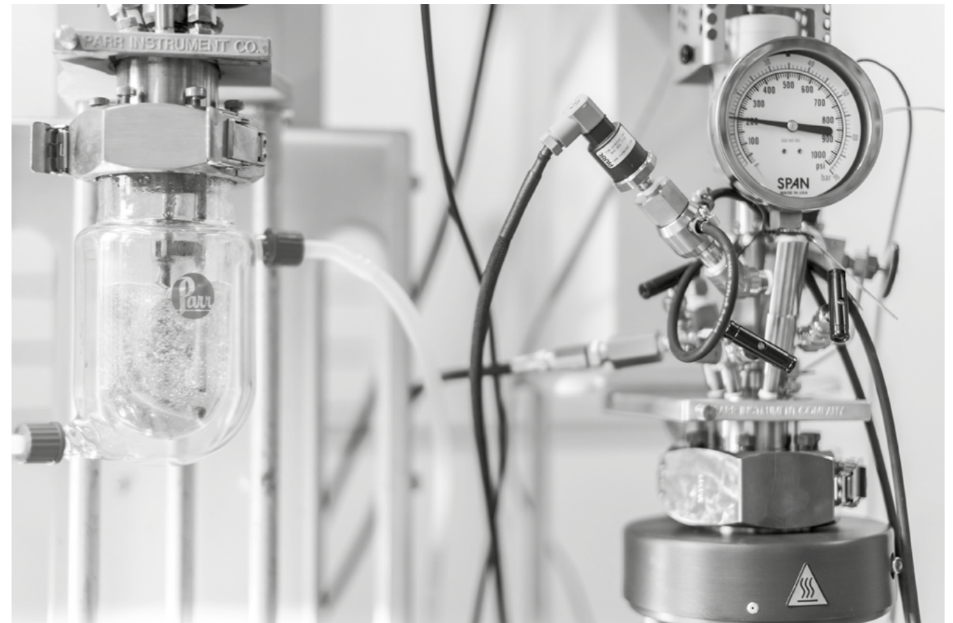
(4) Autoklave zur Dreiphasenkatalyse unter Hochdruck. Quelle: RUB, Arbeitsgruppe M. Muhler
