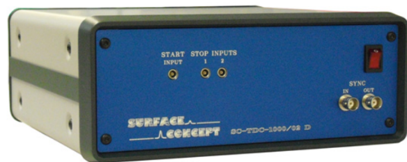
Abbildung 3.12: TDC von Surface Concepts mit einem Start- und zwei Stop-Eingängen, betrieben im Stop-Stop-Modus. Der erste Stop-Eingang ist für den Start-, der zweite Stop-Eingang hingegen für den Stop-Trigger reserviert.
