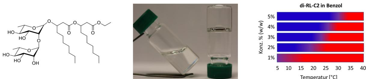
**Abbildung 1.2:** Strukturformel von Dirhamnolipidethylester (links), Dirhamnolipidethylester in Benzol bei hoher Temperatur und bei Raumtemperatur (Mitte) sowie das Gelphasendiagramm von Dirhamnolipidethylester in Benzol bestimmt mit der „drop/flow“-Methode (Blau = Gel, Rot = Lösung, Violett = Übergangsbereich).
